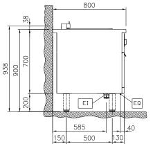
El = Electrical inlet (power) Equipotential screw
